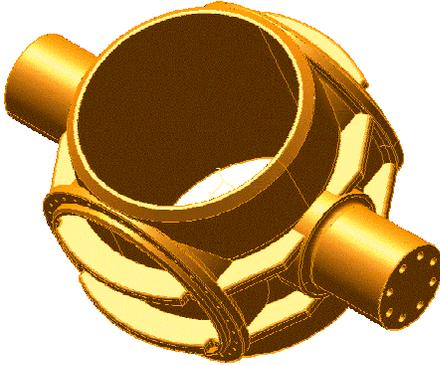
Les particularités de la conception des robinets sphériques permettent d'obtenir une excellente étanchéité même sous de très hautes pressions. Cette conception permet aussi des pertes de charge pratiquement nulles car en position ouverte la section d'écoulement n'est pas obstruée.
